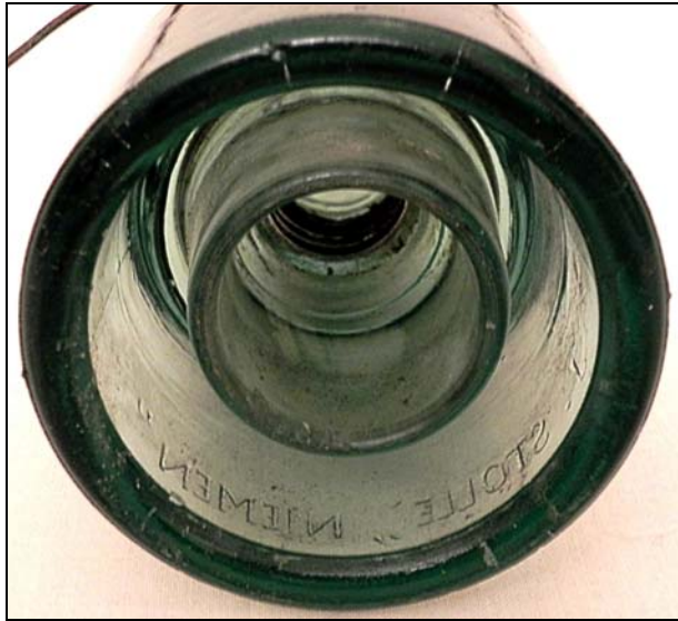
Abb. 2016-2/15-02b; (Maßstab ca. 100 %) Isolator aus grünem Pressglas, H 10,5 cm, D 7,5 cm eingepresste Signatur „J. STOLLE NIEMEN“ Sammlung Blog Zbieracz Glaswerk : Stollen, Niemen, bis 1939?
