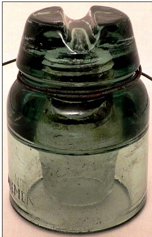
Abb. 2016-2/15-02a; (Maßstab ca. 100 %) Isolator aus grünem Pressglas, H 10,5 cm, D 7,5 cm eingepresste Signatur „J. STOLLE NIEMEN“ Sammlung Blog Zbieracz Glaswerk : Stollen, Niemen, bis 1939?
