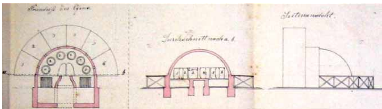
Abb. 2006-4/141 Bauzeichnung von Maurermeister Schmutzler für die 1. Glasfabrik in Radeberg, „praes. den 20. April 1858“ Glasofen Grundriss, Querschnitt, Seitenansicht; Ausschnitt aus der Kopie Nr. 2861, Stadtarchiv Radeberg
