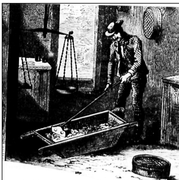
Abb. 2006-4/130 Mischen des Glasgemenges durch Hacken aus Bockschatz-Henke, G.: „Nur mutig hin zur Feuerstelle“ Westfälisches Industriemuseum, 1988
