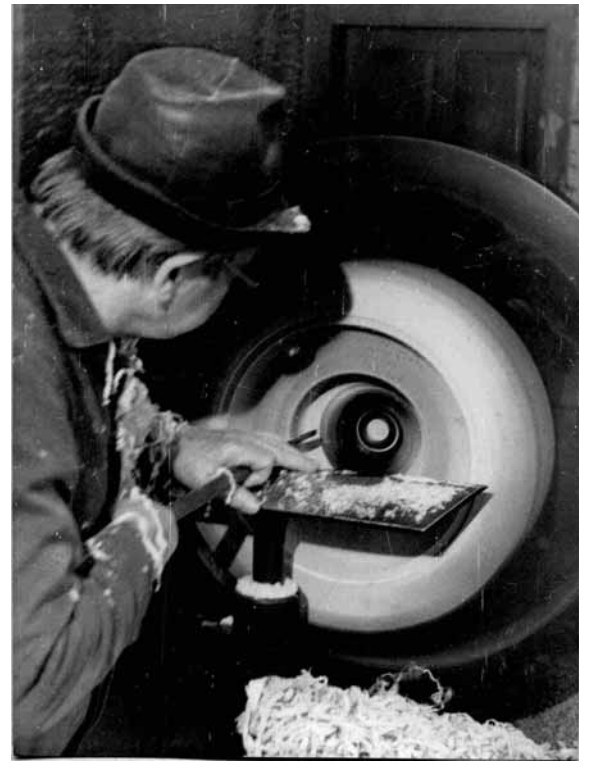
Abb. 2005-4/258 Drehen von Glasformen aus Holz Foto Kirsche
