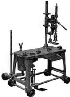
Abb. 2005-3/450 Halbautomatische Saugblasmaschine „Piccolo“ für die Fertigung von Flakons in kleinen Stückzahlen Fr. Wilh. Kutzscher GmbH, Kiel-Wik, Walterwerk Maschinen und Formen für die Glasindustrie, um 1970 Sammlung Feistner
