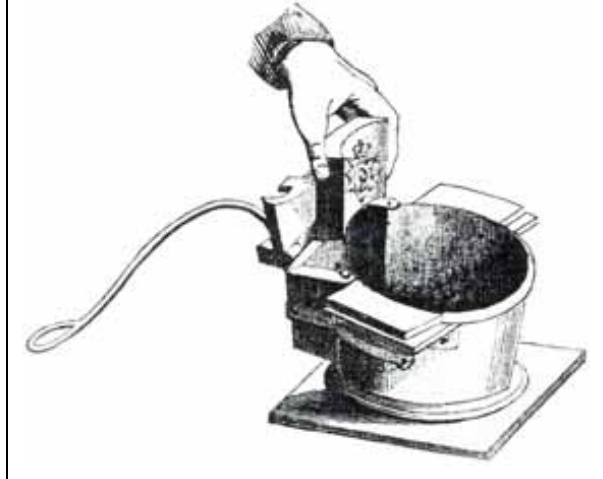
Abb. 2005-1/399 Metallform zur Herstellung von gepressten Pastengläsern aus Apsley Pellatt, Curiosities of Glassmaking, London 1849
