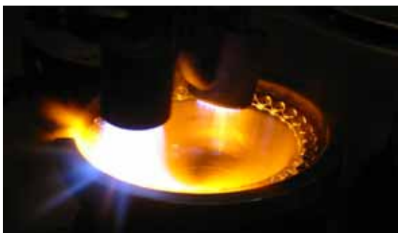
Verwärmen / Feuerpolieren von der Oberseite
