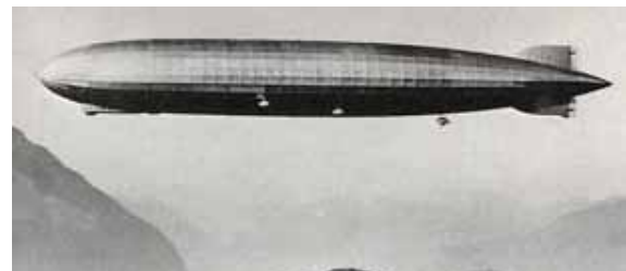
Abb. 2004-1/139 „LZ 127 - Graf Zeppelin, machte 590 Fahrten mit einer Gesamtstrecke von 1.690.000 km, dabei wurden 34.000 Passagiere befördert. Länge: 236,6 m, max. Durchmesser: 30,5 m, max. Geschwindigkeit: 110,2 km/h, Motorisierung: 5 mal 530 PS Maybach, erste Fahrt: 18.09.1928“ aus www.pilotundluftschiff.de/typenzl129.htm
